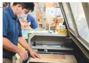
パソコンからデータを入力することで裁断や彫り込みができるレーザー加工機。
