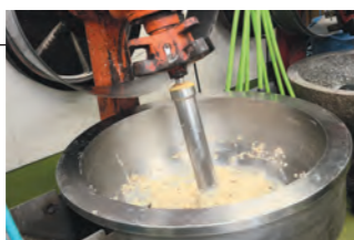
独特の「ひき」を生み出す杵と臼の機械。その臼の気温によって練り合わせる時間を微調整します。
