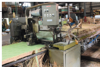
畳床を作る専用の機械。均一に並べられた藁を圧縮して、糸で縫い合わせます。
