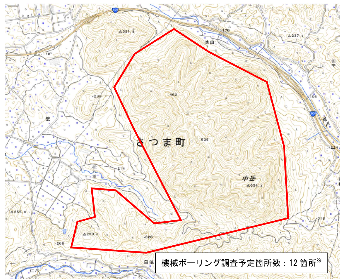
図-1 機械ボーリング調査実施予定エリア（赤枠は範囲のイメージ） ※ 本調査期間で実施する予定の箇所数
