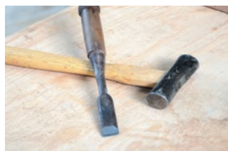
折尾さんが愛用する「のみ」と「げんのう」。のみをげんのうで叩いて木材に穴を掘ります。
