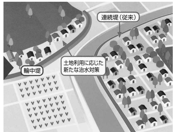
水防災方式（輪中堤）
