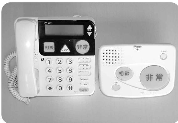
電話型（左）とボックス型の緊急通報システム
