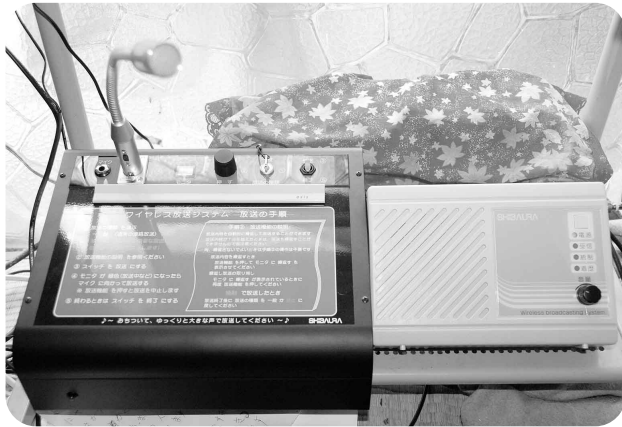
有線放送施設を無線放送施設に変更 左から親機，戸別受信機
