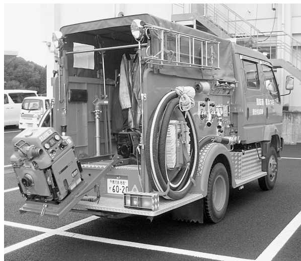
自動車ポンプへの小型ポンプ積載状況
