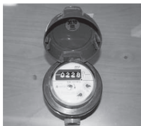
定期的に取り替えを行う水道メーター
