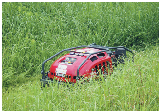
ラジコン草刈り機で法面の草を刈る様子
