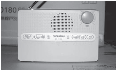
設置予定のデジタル防災行政無線の戸別受信機
