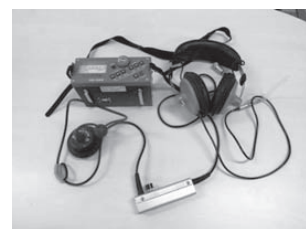
現在使用中の漏水探知機
