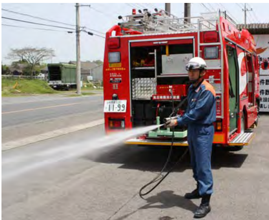
高圧噴霧消火装置での放水
