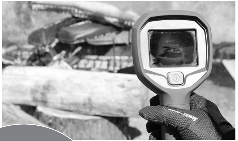
FLIR社 K2 最高温度測定:500℃
