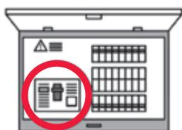
分電盤に内蔵されたセンサーが揺れを感知し、ブレーカーを切って電気を遮断します
