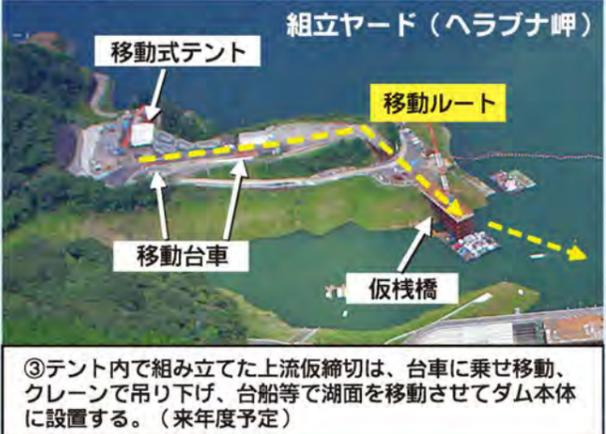
③テント内で組み立てた上流仮締切は、台車に乗せ移動、クレーンで吊り下げ、台船等で湖面を移動させてダム本体に設置する。（来年度予定）
