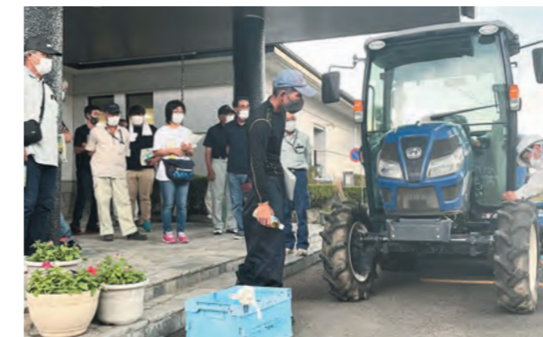
トラクタのエンジン回りの日常点検を説明
