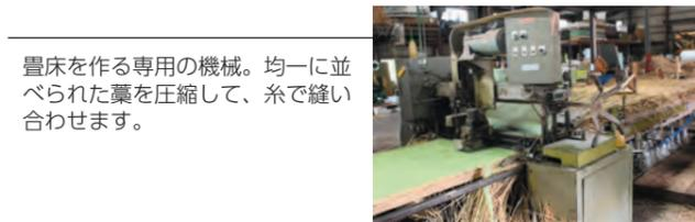
畳床を作る専用の機械。均一に並べられた藁を圧縮して、糸で縫い合わせます。
